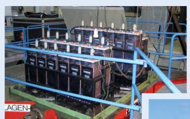
POWER PLANT RACKS SHAKING TEST
